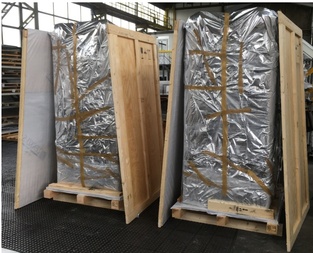
Rys 3. Pakowanie rozdzielnic stojana
