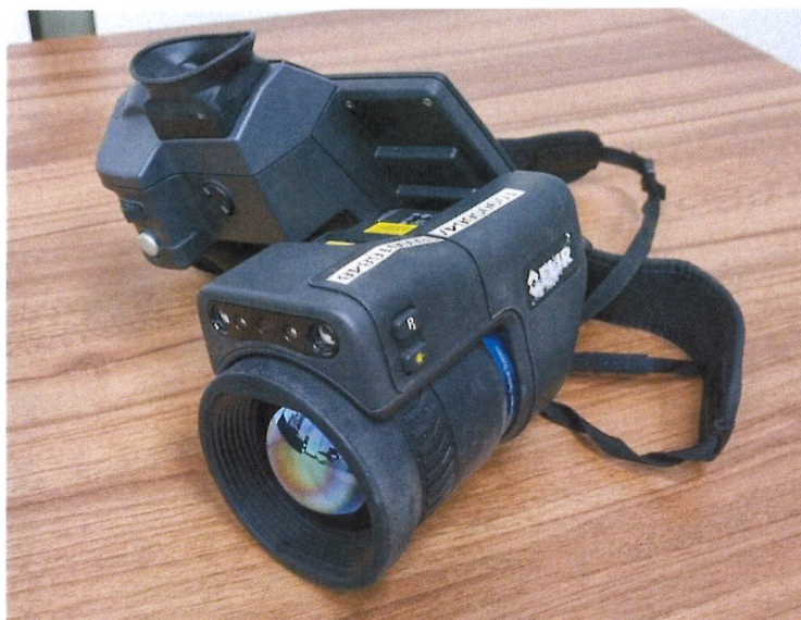
Rysunek 2. a) miernik wilgotności i temperatury, anemometr (miernik prędkości wiatru); b) kamera termowizyjna FLIR T1020.
